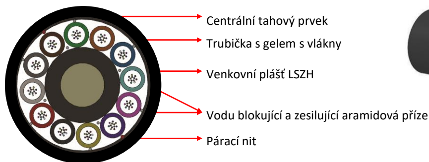
Příklad struktury kabelu (144 vl. 12x12)
