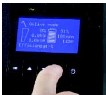
Displej 9SX lze naklonit o 45° pro snadnou čitelnost
